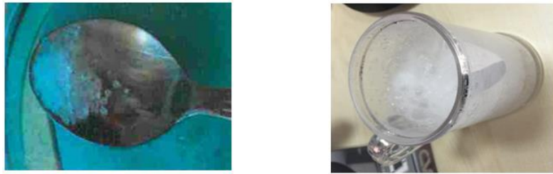
Şekil 8. Suya eklenen sitrik asit ve H 2(g) üretimi
