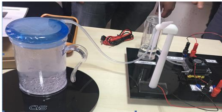
Şekil 9. H 2(g) üretilirken tank kapağının kapatılarak düzeneğe bağlanmış hali
