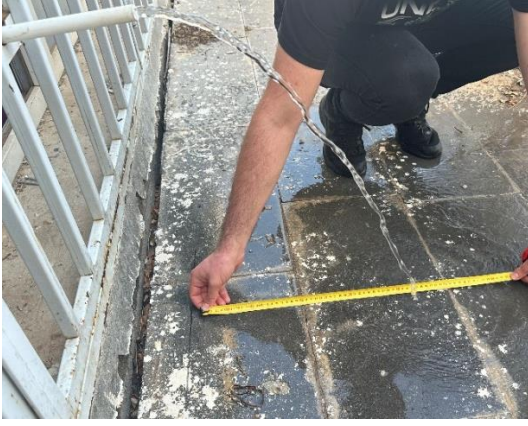
Şekil 5 Su jeti uzunluklarının ölçülmesi
