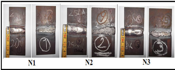
Şekil 3. Kaynaklı birleştirmelerin ön ve arka dikiş makro resimleri (Front and rear stitch macro images of welded joints)
