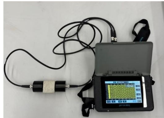
Şekil 2. Ultrases geçiş hızı deney düzeneği(Ultrasonic pulse velocity test setup)
