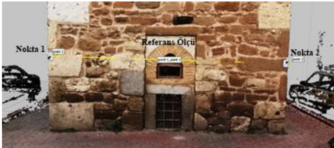
Şekil 10. Model Üzerinde İşaretçiler Arasında Referans Ölçünün (5m) Girilmesi
