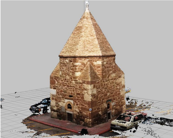
Şekil 6. HD (720p), 80 Fotoğraf, Yoğun Nokta Bulutu, 1.043.591 Nokta
