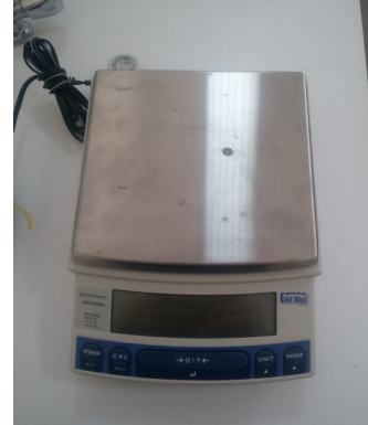
Şekil 1. Anestezi ilaç dozlarının saptanması amacıyla canlı ağırlıkları ölçümlerinin yapıldığı hassas terazi
