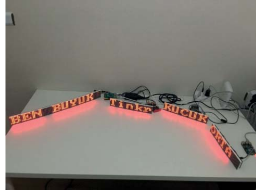
Şekil -15: Dört farklı boyutta tabela ile sistemin çalışır hali
