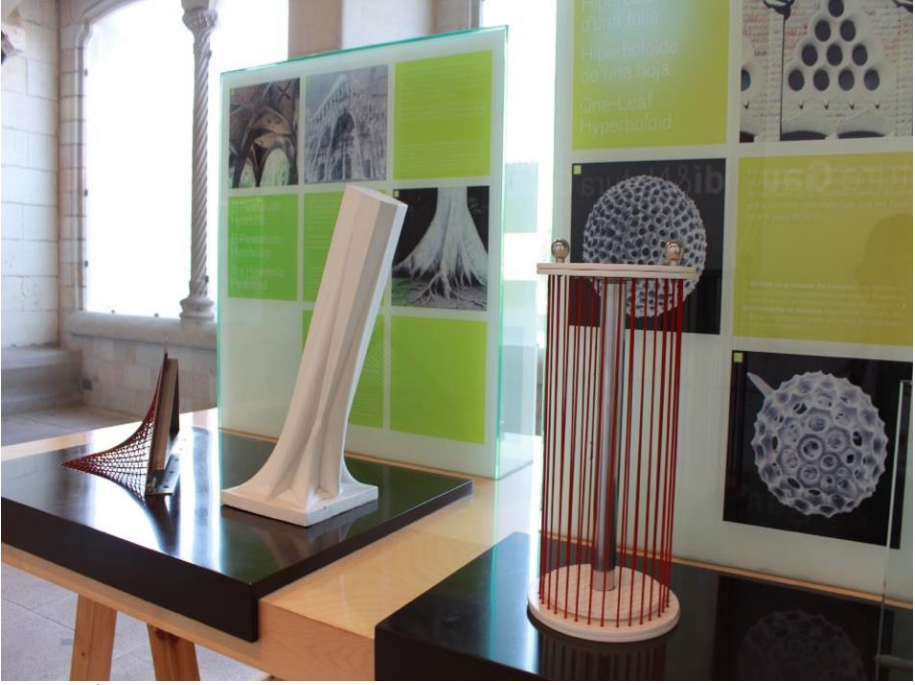
Şekil 3. İspanya, Barselona'daki Sagrada Familia'da sergilenen mimari elemanların sicim modelleri. Fotoğraf: Yazar arşivi, 2010.
