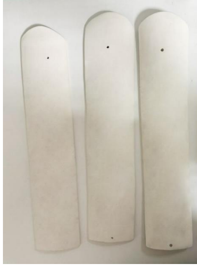
Şekil 3. Çini Çamurundan Elde Edilen Plakalar, Üçüncü Parçaların Görünümü
