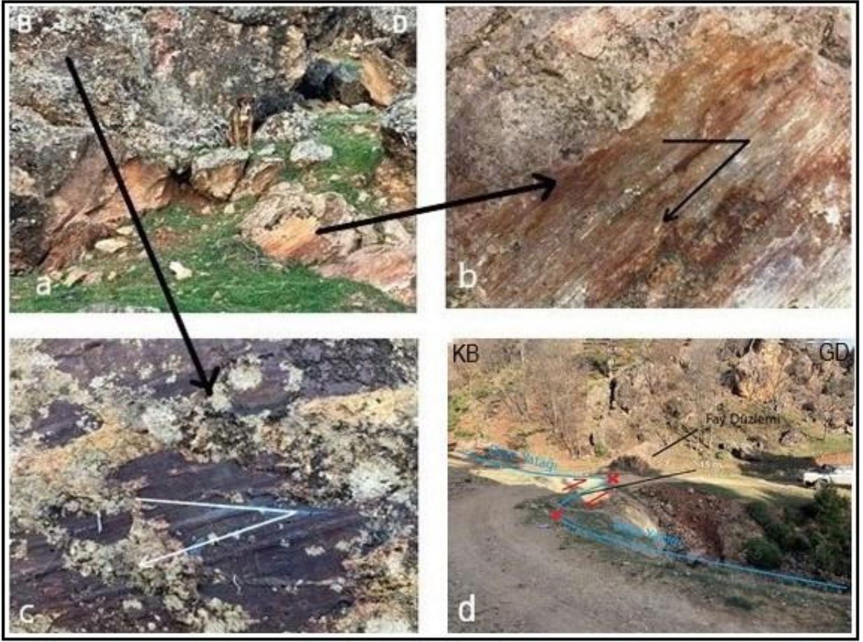
Şekil 5. Gökler Beldesi kuzeyi Çukurören Fayı batı segmenti a) Fay düzlemleri, b) Çukurören Fayı batı segmenti Gökler Beldesi Üçpınar mevkiinde sola sıçrama yaptığı düzlemden fay çizikleri c) Üçpınar mevkiinde fay düzlemi K55 B 85GB rake:18 KB, d) Dere yataklarında sağ yanal yönde gözlenen yaklaşık 15 metrelik ötelenmeler
