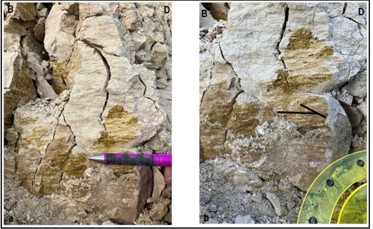
Şekil 3. Çukurören Fayı'nın batı Segmenti Işıklar Köyü girişi a) Fay düzlemi b) Düzlem üzerinde kayma çizikleri c) Kinematik ölçüm K50^{\circ}B\ 85^{\circ}GB rake: 16^{\circ} KB Sağ yanal doğrultu atımlı fay.
