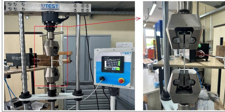
Şekil 2. Çekme testi düzeneği görseli (Tensile test setup caption)
