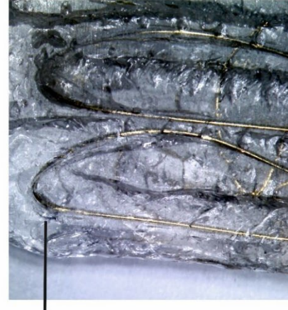
Yazdırma yönünün deđiştii kenarlarda telin bükülmesi
