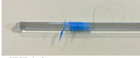
Şekil 2. Geri dönüştürülmüş HDPE elyaf
