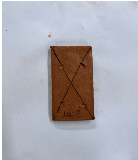
Fotoğraf 15: No 2 Olarak Adlandırılmış Kil Örneğinin 10x5 cm Ölçülerinde Basılmış Plaka Örneği.
