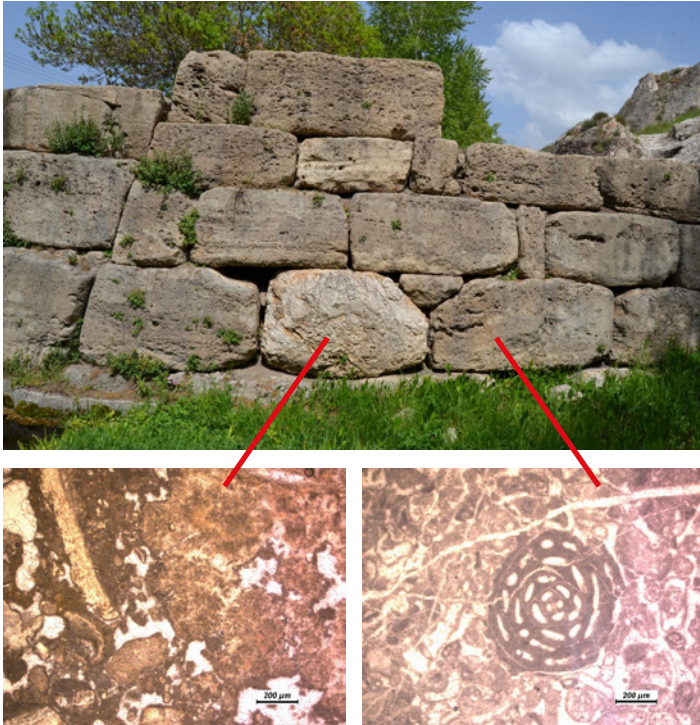
Fig.4- Sardurburç Yapısı temelinde kullanılan kireçtaşı bloğun ince kesit görüntüsü (sol) ve traverten blokların ince kesit görüntüsü (sağ).
