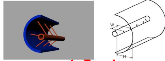
Şekil 5. (a) Sıcak hava ile buz önleme sistemi besleme hattının şematik gösterimi (hot-air impingement system), (b) hava jeti uygulamasındaki geometrik parametreler (parameters of the hot-air impingement system) ( W : iki jet arasındaki mesafe (jet-to-jet spacing), H : jet ile uygulanan yüzey arasındaki mesafe (jet-to-impingement surface distance) ve d : jet çapı (jet diameter), [53]).
