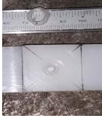
Şekil 8. Doksan saniye takım bekleme süresinde karşılaşılan hata resmi.
