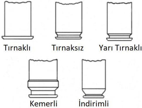
Şekil 2. Mermi kovanlarının farklı tipleri (Zhao vd. 2014)
