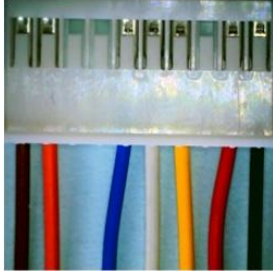
Şekil 15 Daralan boş priz yuvası aralığı (Narrowing empty socket gap)
