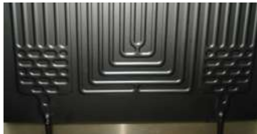
Şekil 3. Sistemde kullanılan buharlaştırıcı numunesi için giriş ve çıkış manifoldları.
