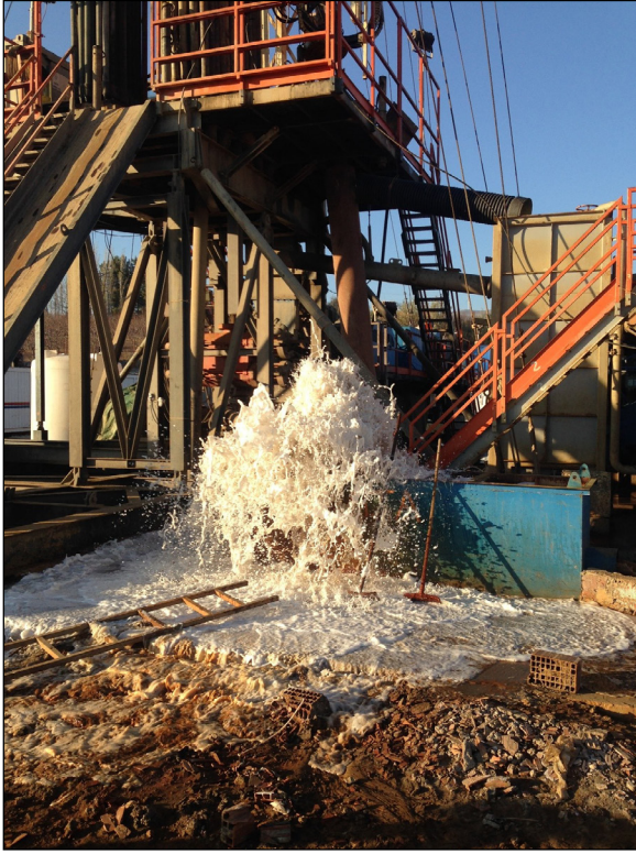
Şekil 13- AMÇ-2016/3 jeotermal sondajı asitleme sonrası üretim çalışmaları.
