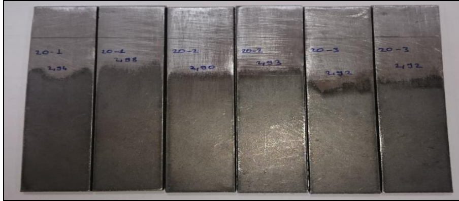
Şekil 2. Yapıştırma Yüzeylerinin Hazırlanması
