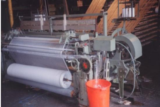
Şekil 11. SIN FON 35-CP Leno Dokuma makinesi (www.allproducts.com, 2012)
