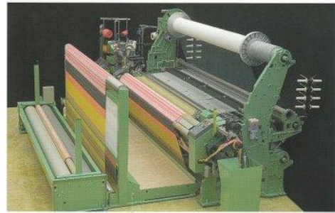
Şekil 16. Dornier Easy Leno 2T ile Donatılmış Hava Jetli Dokuma Makinesi ( www.ambience.com ,2011; Anonim A, 2011).
