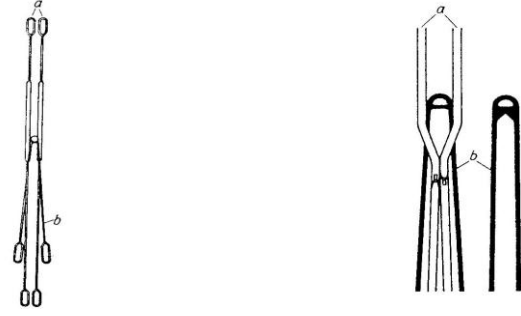
Şekil 5. Çelik Telli Döner Gücü Çeşitlerinin Şematik Gösterimleri (İmer, 1989)
