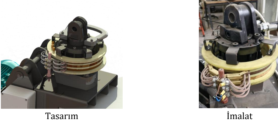
Şekil 5. Slip-Ring tasarım ve imalatı
