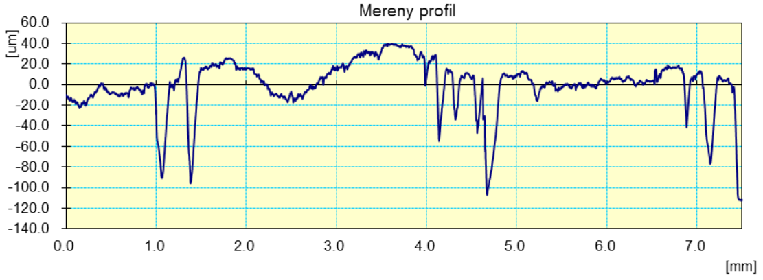
Şekil 6: Cz meşe odunu için liflere dikey yönde yüzey pürüzlülüğü ölçümleri sonucu elde edilen grafik örneği.
