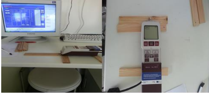
Şekil 1: Yüzey Pürüzlülüğü ölçme aleti, Foto: O., Okcu.
