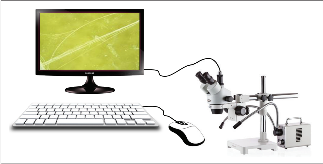
Şekil 4. Elyaf çaplarındaki değişim için makroskobik test düzeneğinin sembolik görünümü.
