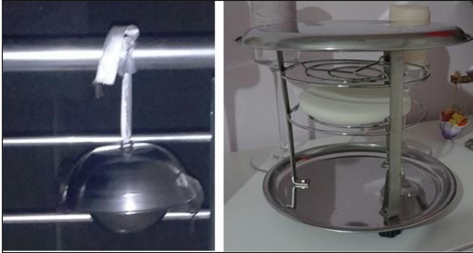
Şekil 2: Dış ortam ve iç ortam pasif hava örnekleyicileri
