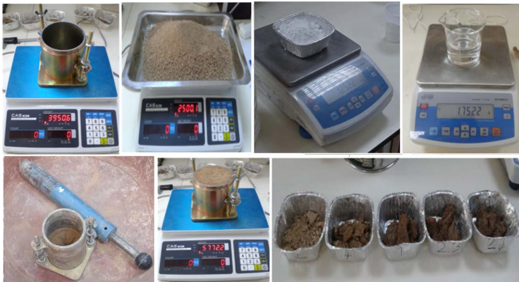
Şekil 3. Standart proktor deneyi aşamaları
