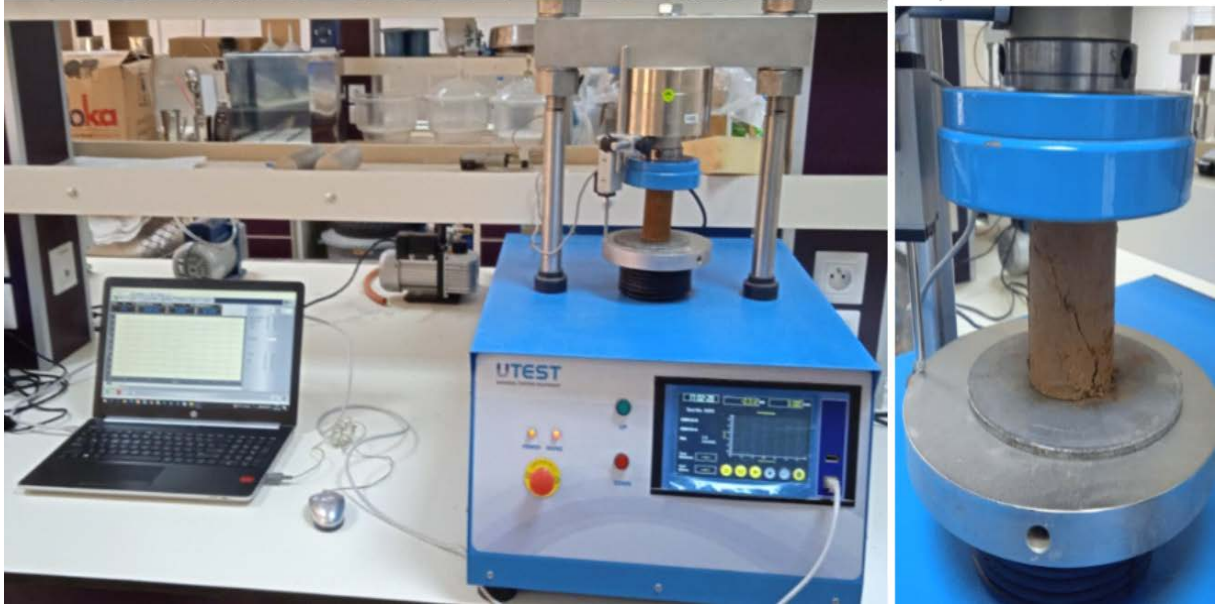
Şekil 4. Serbest basınç deneyi seti ve deney sonucu oluşan deformasyon
