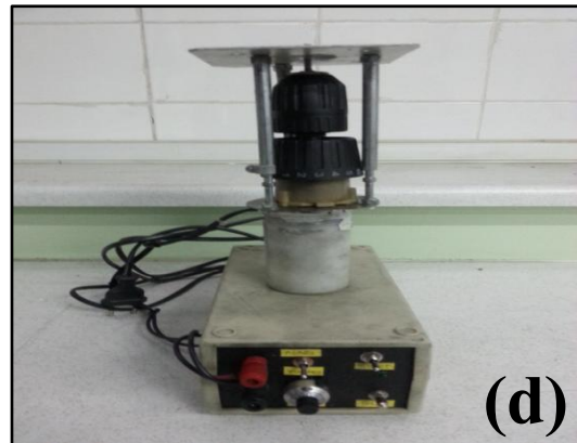
Şekil 1. (a) Deney düzeneğinin blok diyagramı, (b) Bridgman-tipi kontrollü doğrusal katılaştırma fırınının detayları, (c) Farklı senkron motorlar, (d) Yüksek katılaştırma hızları için tasarlanan motor-çekme sistemi.
