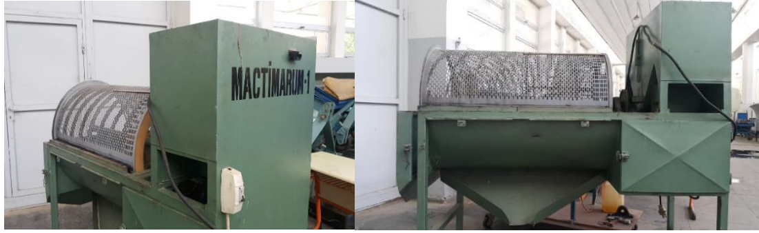
Şekil 1. Simülasyonu yapılan deneysel iç yer fıstığı sınıflandırma makinesi ve silindirik elek
