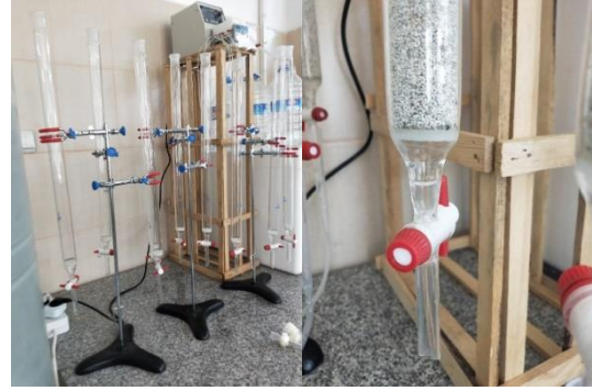
Şekil 1. Çalışmanın yapıldığı kolon deneme düzeneği
