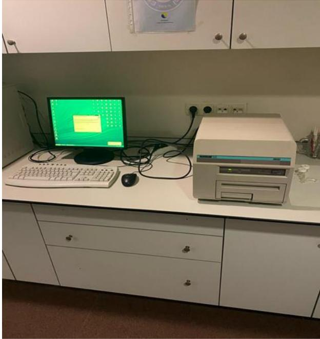
Figure 7. Thermoluminescence Dosimeter
