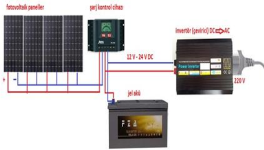
Şekil 3. Kurulan tuzakların elektrik şeması (sol) ve arazideki kurulumu (sağ)
