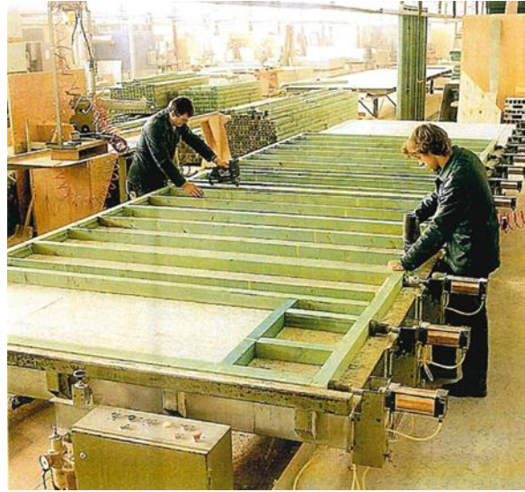
Şekil 11. Platform çerçeve sistemde duvar çerçevesi oluşturulması [2]
