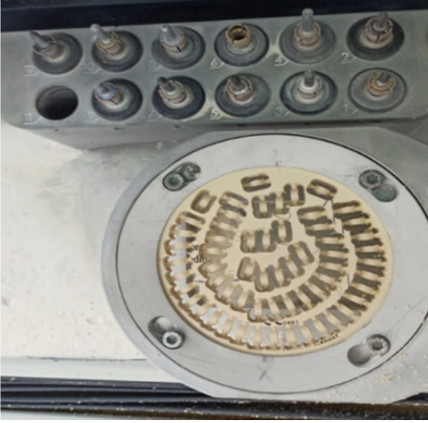
Resim 1. CAD/CAM yöntemi ile daimi PEEK bloktan elde edilen örnekler
