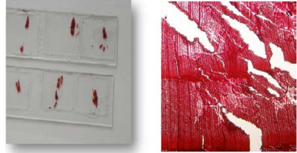
Şekil 1. Parafine gömme işlemi yapılmayan ısıl işlem görmüş bir ladin örneğinin preparat ve enine kesitinin mikroskopik görüntüsü (x4)
