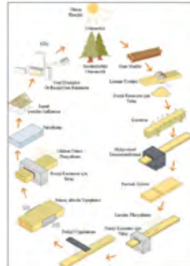
Görsel 2-3. Glulam Malzemenin Çizimi (URL1), Üretim Aşaması (URL2)
