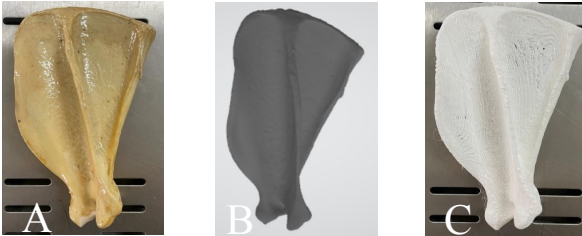
Şekil 4. Scapula iskeleti, dijital görünüm ve 3D yazıcı modeli.: A. Gerçek kemik, B. 3D dijital kemik, C. 3D kemik.
