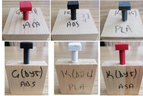
Şekil 6. Kavala tutma deneylerinde gözlemlenen deformasyon karakteristikleri
