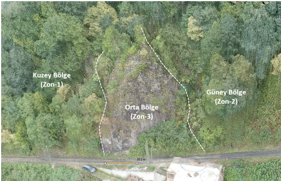
Şekil 5. Çalışma alanının Dearman vd. (1987) sınıflama sistemine göre 3 farklı jeoteknik bölgeye ayrılması.
