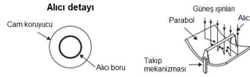
Şekil 1. Bir PTC'nin sistematigi (Kalogirou, 2013)
