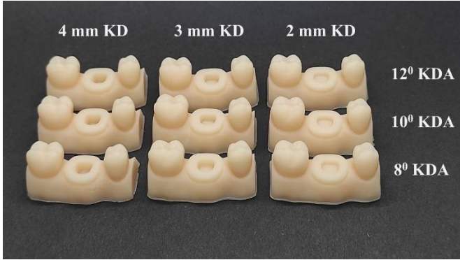
Şekil 1. Çalışmada kullanılan farklı kavite derinliğindeki (KD) ve farklı kavite duvarı açılmasındaki (KDA) endokron kavite preparasyonları.
