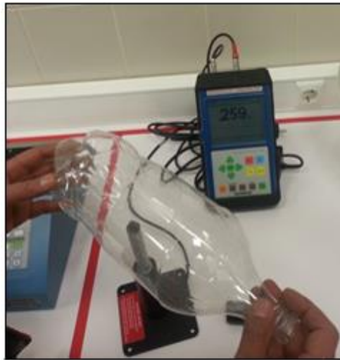
Şekil 3. Bilyalı kalınlık ölçüm cihazı
