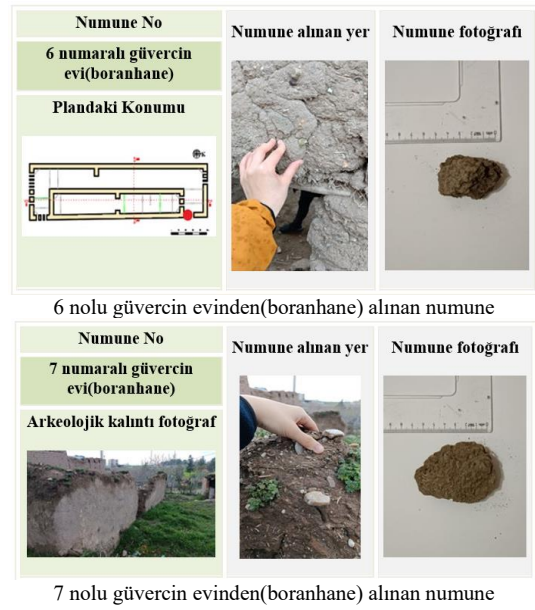
Şekil 13. SEM-EDX deneyi için hazırlanan numuneler (2024)
