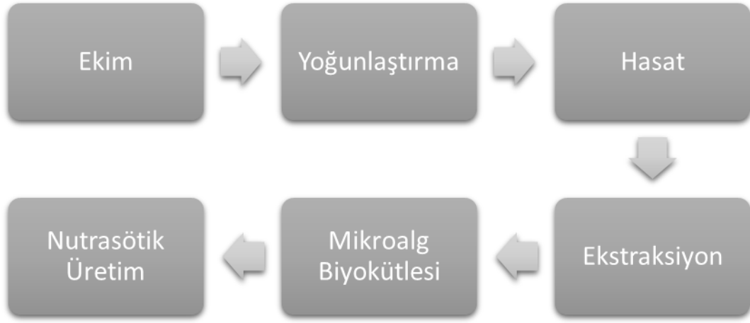
Şekil 3. Mikroalg biyokütle üretiminin proses akış diyagramı [29]
