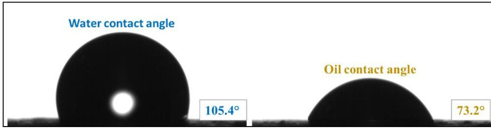
**Figure 8.** Water and oil contact angles of ZrO<sub>2</sub> coated CP-Ti (ZrO<sub>2</sub> kaplı CP-Ti'nin su ve yağ temas açıları)
