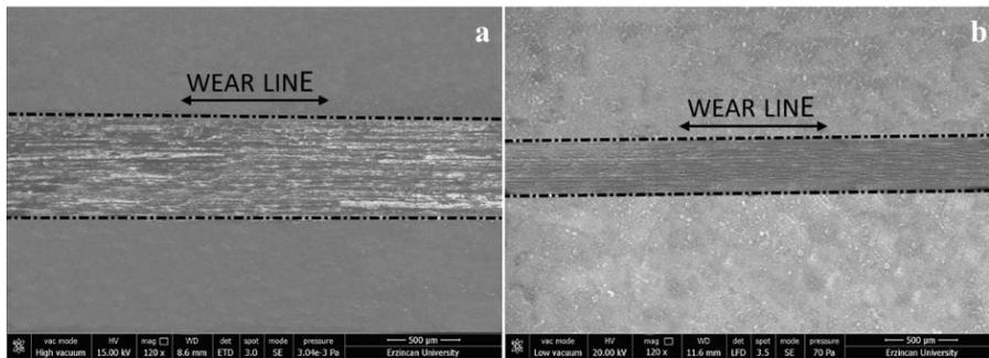
**Figure 7.** SEM images of wear tracks: (a) bare CP-Ti, (b) ZrO<sub>2</sub> coated CP-Ti (Aşınma izlerinin SEM görüntüleri: (a) kaplamasız CP-Ti, (b) ZrO<sub>2</sub> kaplı CP-Ti)
