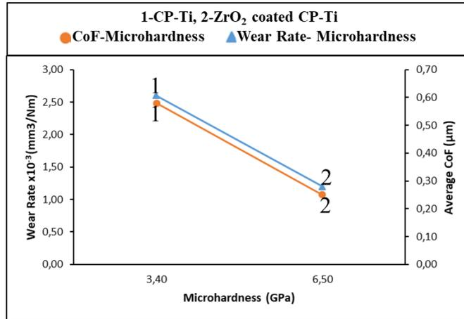
**Figure 6.** Relationship of wear rate and friction coefficient to hardness of bare and ZrO<sub>2</sub> coated CP-Ti samples (Kaplamasız ve ZrO<sub>2</sub> kaplı CP-Ti numunelerinin aşınma oranı ve sürtünme katsayısının sertlikle ilişkisi)
