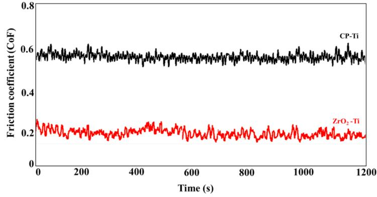
**Figure 5.** Friction coefficient-time graph for bare and ZrO<sub>2</sub> coated CP-Ti samples (Kaplamasız ve ZrO<sub>2</sub> kaplı CP-Ti numuneler için sürtünme katsayısı-zaman grafiği)
