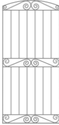
Şek.10- Anafartalar Caddesi No:822’de bulunan zemin kat penceresine ait metal şebekenin çizimi.
