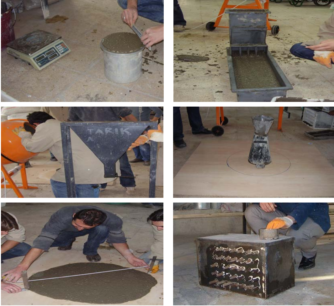
Şekil. 1. KYB özelliklerinin belirlendiği taze beton deneyleri
