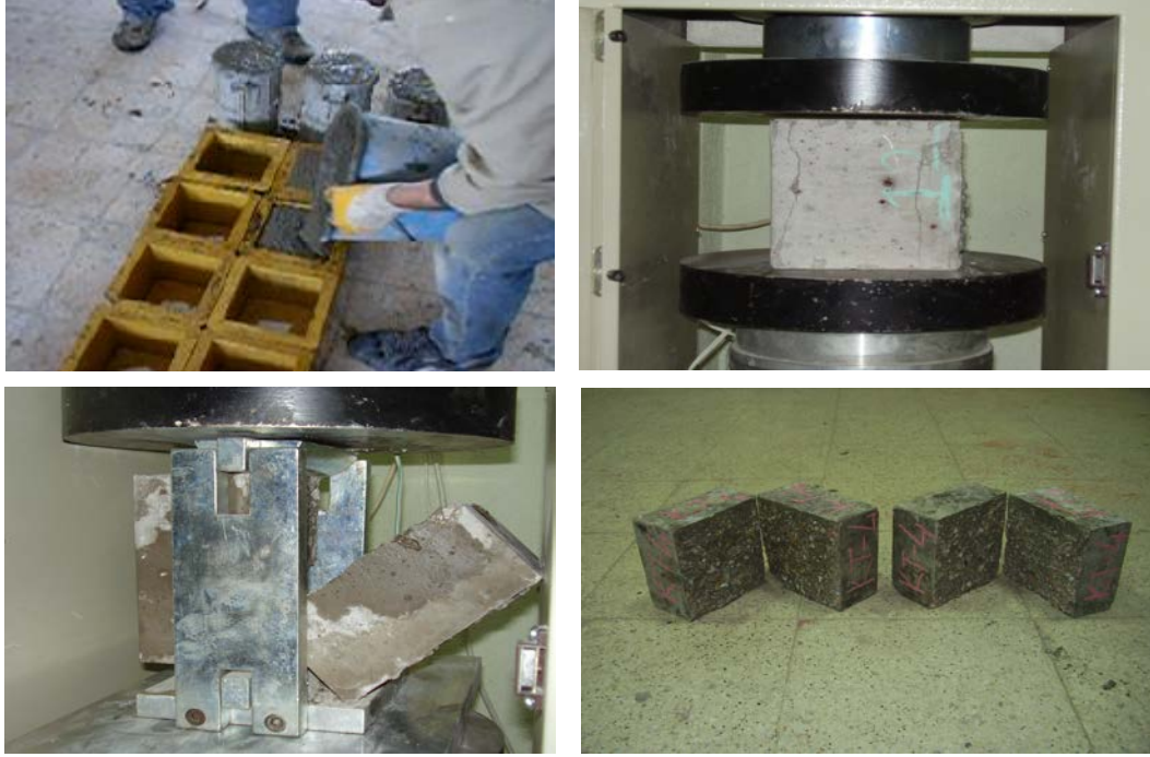
Şekil 2. Kalıba yerleştirilen KYB numuneleri ve sertleşmiş beton deneyleri
