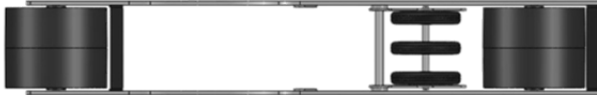
Şekil 6. Ön ve arka baskı tekeri lastik ve baskısı yayla ayarlanabilir orta üçlü dar lastik (BT 3 )
