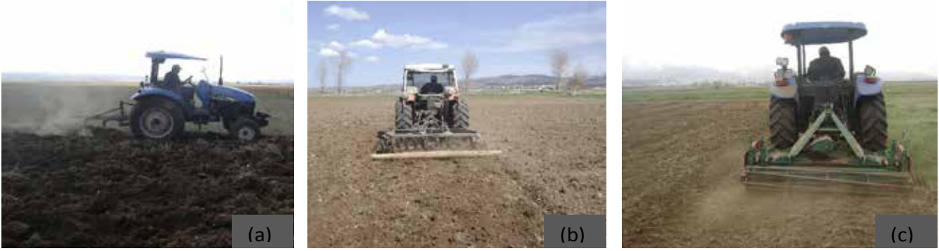
Şekil 1. Toprak işleme yöntemleri; pulluk (a), diskli tırmık ve sürgü (b), dik freze ve dönel tırmık (c)
