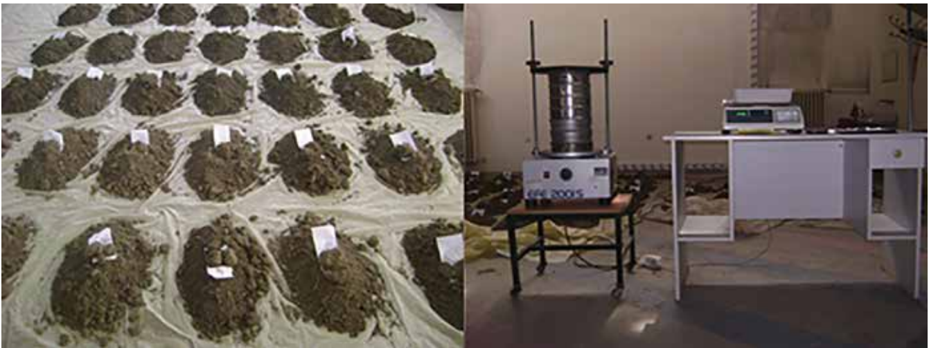
Şekil 2. Toprak örnekleri ve elek sarsıcı
